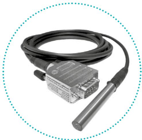
Der OFT-420 Messumformer misst die relative Feuchte und Temperatur in der der Raumluft. Dieser Messumformer besitzt zwei Analogausgänge mit 4...20 mA. Der integrierte 32-Bit Prozessor und eine ausgefeilte Software erlauben ein Höchstmaß an Präzision. Aufgrund der modularen Bauweise eignet sich dieser Sensor besonders für den industriellen Einsatz.
